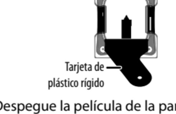
**7** Utilice la tarjeta de plástico rígida para presionar el protector de pantalla contra la esfera de su reloj.
