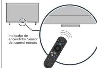
Indicador de encendido/ Sensor del control remoto
