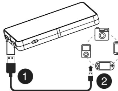
**1** Brancher la grande extrémité du câble USB inclus dans les port USB **OUT** de la batterie.
