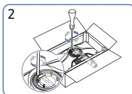
Serrez les vis en haut du tube de support.
