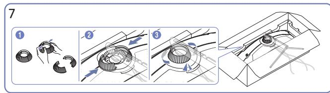
Enlevez le CACHE ARRIÈRE SUPÉRIEUR. Fixez le CACHE ARRIÈRE SUPÉRIEUR au tube du support, comme indiqué sur la figure. Faites tourner le CACHE ARRIÈRE SUPÉRIEUR dans le sens des aiguilles d'une montre.
