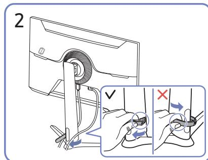
Tirez sur le côté droit du CÂBLE DU SUPPORT DU GUIDE pour le retirer du support. Le côté gauche du CÂBLE DU SUPPORT DU GUIDE peut s'endommager si on tire dessus avec force.
