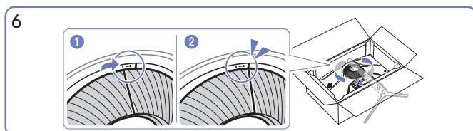
Faites tourner le CACHE ARRIÈRE SUPÉRIEUR dans le sens des aiguilles d'une montre.
