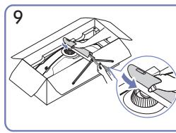
Poussez la PARTIE ARRIÈRE DU CORPS DU SUPPORT dans la direction indiquée sur la figure.
