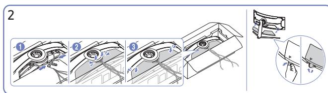
Rassemblez les câbles et alignez-les sur la rainure centrale du CACHE ARRIÈRE INFÉRIEUR. Montez le CACHE ARRIÈRE INFÉRIEUR à l'arrière du produit.
