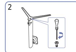
Serrez la vis sur la partie inférieure de la base du support. Fixez la grande vis au milieu pour l'assemblage.
