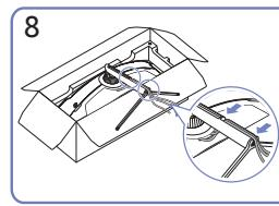
Placez les câbles correspondants dans le logement du bras de support. N'étirez pas le câble. Nous recommandons de placer trois câbles dans un logement.
