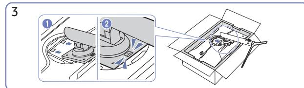
Poussez le support assemblé dans le corps principal dans le sens de la flèche, comme indiqué sur la figure.
