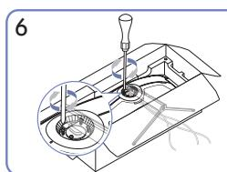
Serrez les vis en haut du tube de support.
