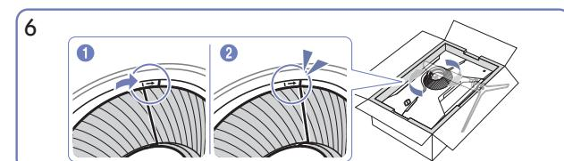
Faites tourner le CACHE ARRIÈRE SUPÉRIEUR dans le sens des aiguilles d'une montre.
