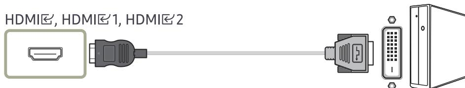
La fonction audio n'est pas prise en charge si le périphérique source est connecté à l'aide du câble HDMI-DVI.
