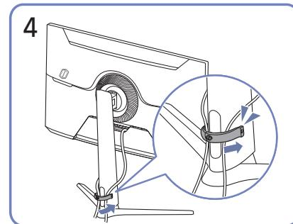
Placez les deux câbles dans le dispositif de maintien de câbles sur le support (CÂBLE DU SUPPORT DU GUIDE) pour organiser les câbles, comme indiqué sur la figure.
