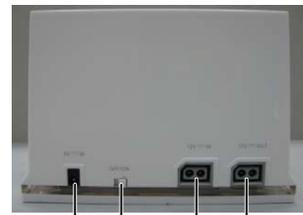
ENTRADA de 5 V, Conmutador LED, ENTRADA de 12 V, SALIDA de 12 V
