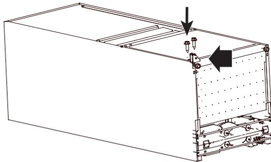
8 Retirer le cache de l'orifice sur le côté supérieur gauche de la porte du réfrigérateur, retirer la chemise d'arbre du côté supérieur droit de la porte du réfrigérateur, puis retirer la butée sur le côté inférieur droit de la porte du réfrigérateur.
