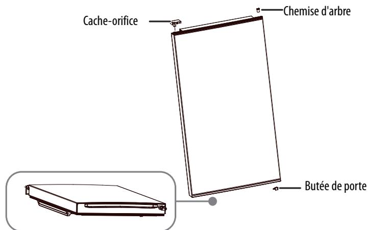
9 Installer le cache de l'orifice du côté supérieur droit de la porte du réfrigérateur, installer la chemise d'arbre dans le côté supérieur gauche de la porte, puis installer la butée dans le côté inférieur gauche de la porte du réfrigérateur.
