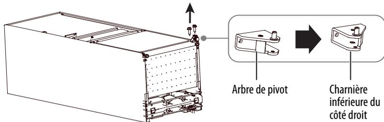
7 Installer l'arbre de pivot de l'autre côté de la charnière inférieure, puis installer la charnière sur le côté gauche du réfrigérateur, à l'aide des vis qui viennent d'être retirées.
