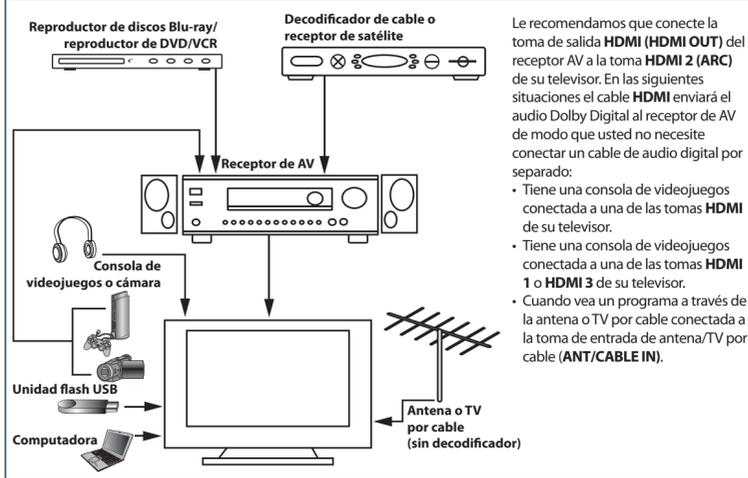
Le recomendamos que conecte la toma de salida HDMI (HDMI OUT) del receptor AV a la toma HDMI 2 (ARC) de su televisor. En las siguientes situaciones el cable HDMI enviará el audio Dolby Digital al receptor de AV de modo que usted no necesite conectar un cable de audio digital por separado:
