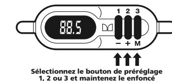
4. Une fois votre station préréglée, l'appareil revient automatiquement au mode "préréglage" par défaut; si vous appuyez alors sur les boutons 1 à 3, les stations préréglées par défaut se réaffichent. Pour modifier les préréglages, répétez les étapes 1 à 3.
