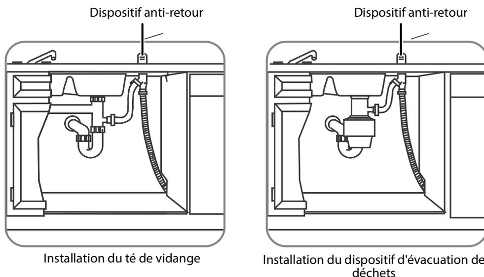
**Méthode 2 : circuit de drainage élevé à té de vidange ou dispositif d'évacuation de déchets**
