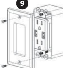
**9** Fije la placa de pared al tomacorriente con cargador con los dos tornillos cortos (suministrados).
