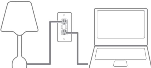
**10** Restablezca la alimentación al reemplazar el fusible o al encender el interruptor del circuito. El tomacorriente con cargador está listo para su uso.
