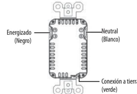
Inserte el alambre enderezado en cualquier de los dos agujeros de los puntos fase y neutro en el lado del tomacorriente. La energía pasa entre los dos agujeros correspondientes para un cableado pasante. Sujete el cable de puesta a tierra en la parte inferior del tomacorriente.
