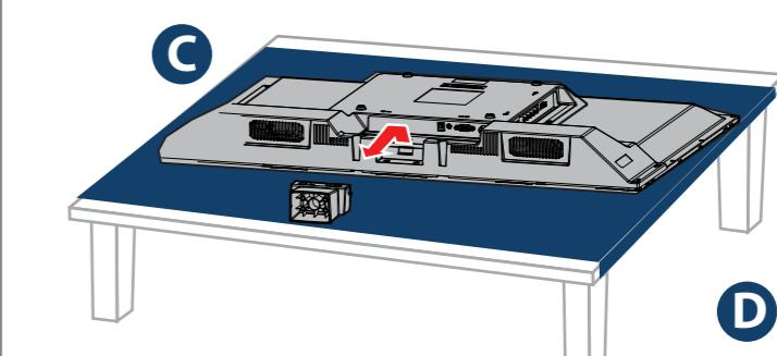
Su televisor tiene cuatro agujeros de montaje VESA en la parte posterior. Si fija un soporte de montaje en pared a la parte posterior de su televisor, **el soporte se debe fijar firmemente**, utilizando los cuatro agujeros. Si usted no utiliza los cuatro orificios de montaje, el televisor podría caerse y causar daños a la propiedad o lesiones personales. Refiérase a los documentos que vienen con su montaje en pared para las instrucciones completas de montaje.
