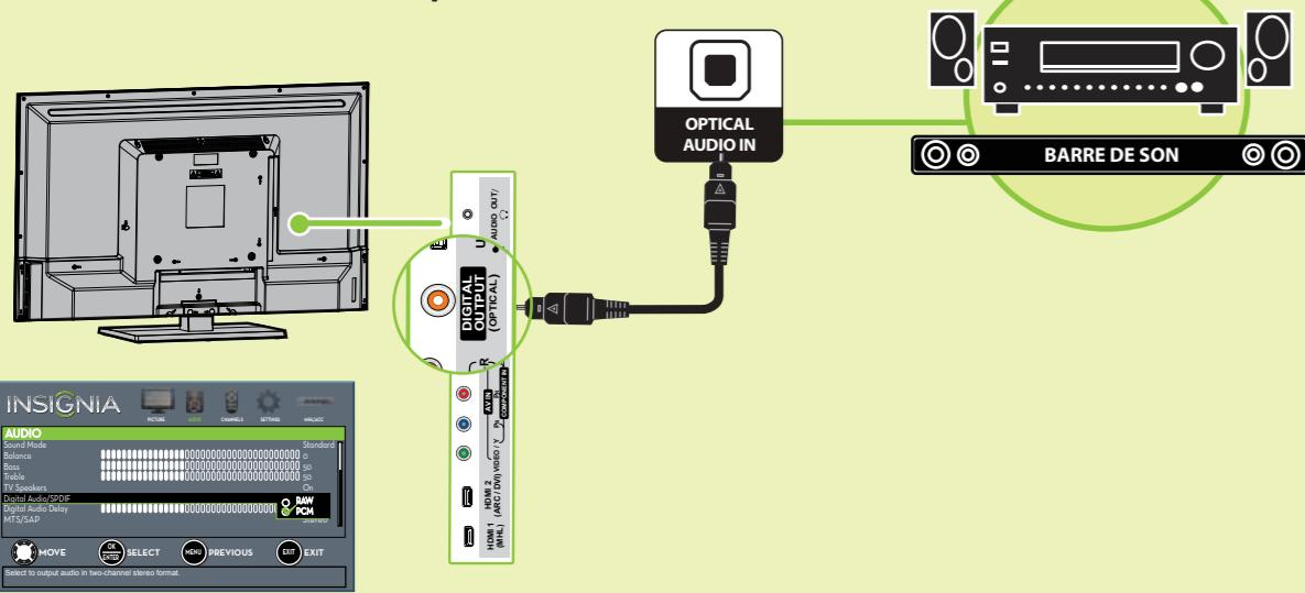
Sur le téléviseur, régler l'option **Digital Audio/SPDIF** (Audio numérique/SPDIF) dans le menu **AUDIO** sur **PCM**.
