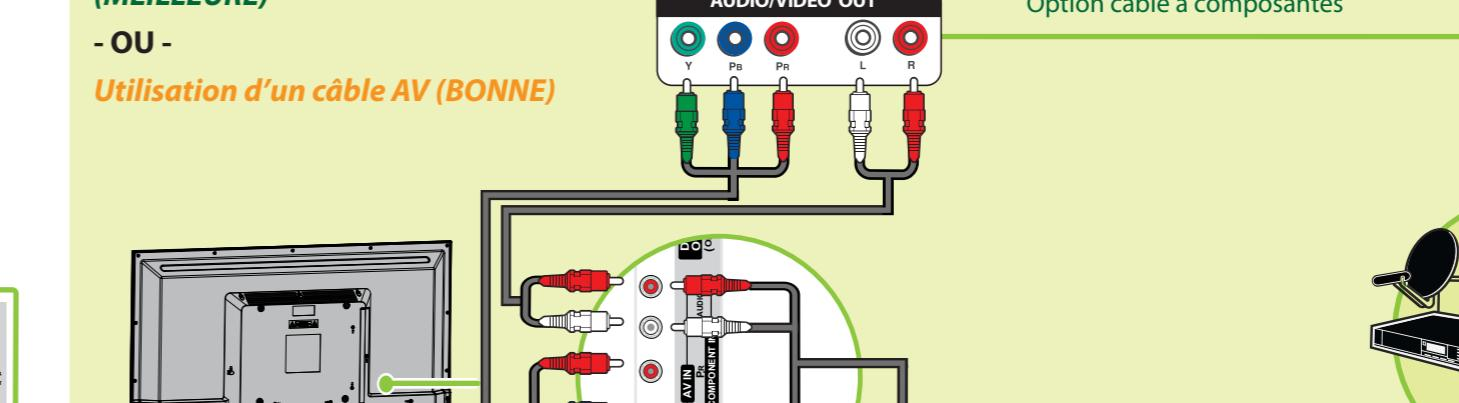
Remarque : Les prises vidéo à composantes et AV sont partagées. Cela signifie qu'il n'est possible de connecter qu'un périphérique vidéo à composantes ou AV à la fois. Il est suggéré d'utiliser HDMI si le périphérique utilisé le permet.
