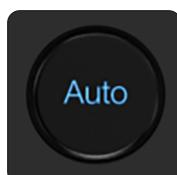
**Touche de gain automatique** – Lorsqu'un canal est sélectionné, appuyez sur la touche Auto pour que la Quantum ES règle automatiquement le niveau de gain du canal sélectionné (**pour plus d'informations sur le gain automatique, voir la section 5.3**). Le gain automatique n'est disponible que pour les entrées microphone et guitare (pas pour les signaux de niveau ligne).
