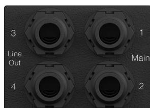
**Sorties pour moniteurs** – Utilisez les deux prises jacks 6,35 mm TRS marquées Main pour brancher votre paire de moniteurs de studio principale. Les sorties pour moniteurs sont également couplées en courant continu pour l'envoi de tensions de commande.
