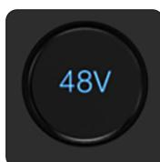
**Alimentation fantôme** – Lorsqu'un canal est sélectionné, appuyer sur la touche d'alimentation fantôme 48V permet d'activer ou de désactiver l'alimentation fantôme ; la touche s'allume en rouge lorsque cette fonction est activée et en bleu lorsqu'elle est désactivée.
