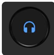
**Touche de contrôle du casque** – Appuyer sur la touche de contrôle du casque permet de contrôler le niveau de sortie par le casque (la molette devient verte). Pour l'ES 2, il suffit d'appuyer à nouveau sur la touche de casque pour revenir au mode de contrôle des enceintes ou d'appuyer sur la touche Main.
