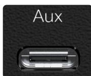
**Connecteur d'alimentation auxiliaire (USB-C)** – Lorsque l'appareil auquel vous êtes connecté ne fournit pas suffisamment d'énergie par l'USB-C, une alimentation auxiliaire par câble d'alimentation supplémentaire (non inclus) est nécessaire.
