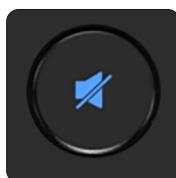
**Touche de coupe (Mute) / Atténuation (Dim)** – Par défaut, appuyer sur la touche Mute coupe les sorties principales (Main). Optionnellement, cette touche peut être configurée dans Universal Control pour fonctionner comme touche d'atténuation (Dim). L'atténuation appliquée est par défaut de -10 dB, mais elle peut être modifiée dans le panneau des réglages (Settings) du mélangeur Universal Control.
