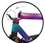
PRESS THE RELEASE LEVER BUTTON TO UNLOCK AND PULL THE LEVER
