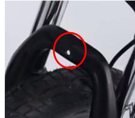
Étape 2 : Faites glisser le garde-boue avant dans la fourche et sur le pneu jusqu'à ce que la languette du garde-boue rencontre la fourche.
