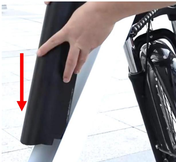
Étape 3 : Réinstallez la batterie en faisant glisser le bas de la batterie dans le compartiment et en faisant glisser la batterie vers le bas pour la verrouiller dans le compartiment.
