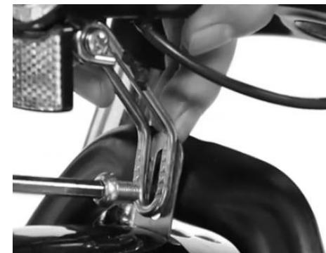
Étape 4 : Alignez les bras de renfort en « U » du garde-boue avec les languettes situées à l'arrière de la fourche avant
