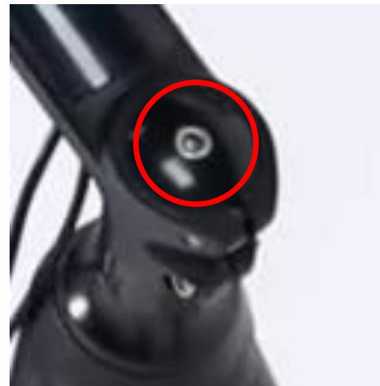
Étape 3 : Une fois le guidon correctement aligné et la vis supérieure serrée, serrez les 2 vis latérales, comme indiqué sur les photos.
