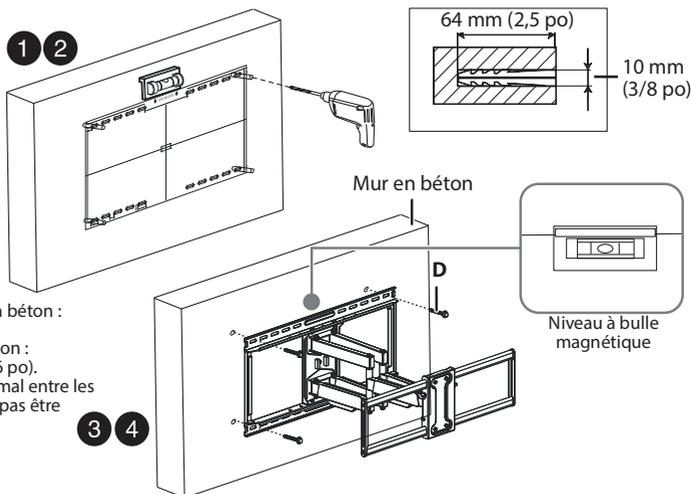
\* Épaisseur minimale du mur en béton : 8 po (203 mm).
