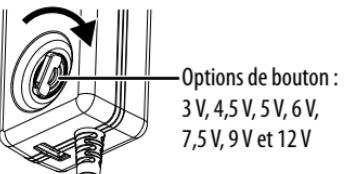
**3** Vérifier la polarité de l'appareil qui est connecté à l'adaptateur pour s'assurer qu'elle est positive. Si l'appareil a une polarité négative, NE PAS utiliser cet adaptateur pour alimenter l'appareil.
