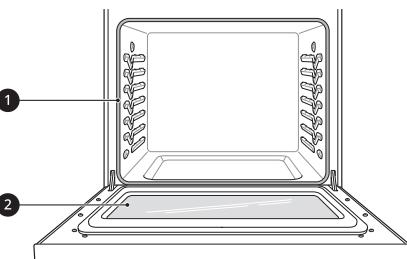
① No limpie manualmente la junta de la puerta del horno
