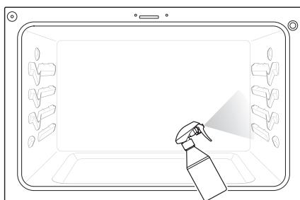
**5** Rocíe o vierta el agua restante (8 oz o 240 ml) en el centro de la base de la cavidad del horno. La hendidura en la base del horno debe estar totalmente cubierta para sumergir toda la suciedad. Agregue agua si fuera necesario.
