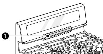
**① Ventilación del horno**
