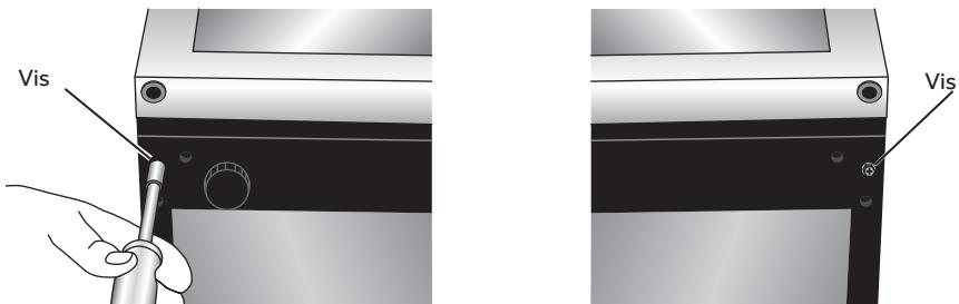
6. Au moyen des trois vis à tête hexagonale retirées précédemment, réinstaller la charnière inférieure sur le côté opposé de la caisse.
