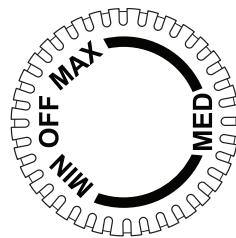
**IMPORTANT :** Le fait de tourner le bouton de contrôle à "OFF" ne débranche pas le centre de boissons de la source d'alimentation électrique.
