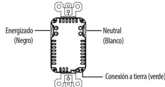
Inserte el cable enderezado en cualquiera de los dos agujeros de las ubicaciones caliente y neutra del lateral de la toma. La energía pasa entre los dos agujeros correspondientes para un cableado pasante. Sujete el cable de puesta a tierra en la parte inferior del tomacorriente.
