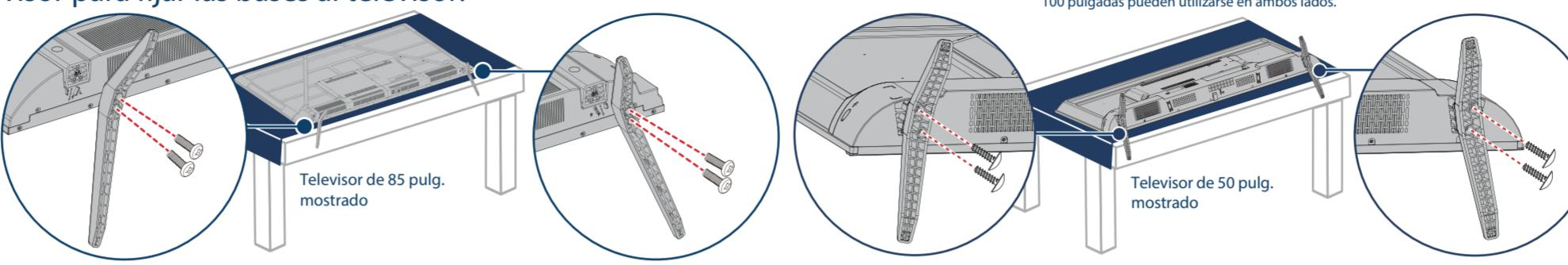
Nota: Las bases para televisores de 50 pulgadas son específicas para la izquierda o la derecha y deben colocarse con las flechas apuntando hacia la pantalla. \* Las bases para televisores de 85 y 100 pulgadas pueden utilizarse en ambos lados.
