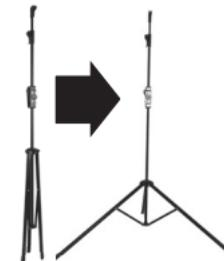
**2** Desserrer the levier de verrouillage de la colonne centrale, puis relever la colonne centrale afin que l'encoche de suspension de l'écran soit juste en-dessous du niveau de l'œil (cette position facilite la fixation du support de suspension de l'écran de projection), puis utiliser le levier de verrouillage de la colonne centrale pour la fixer dans son emplacement.
