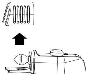
**3** Dévisser et retirer la vieille ampoule.
