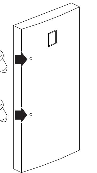
3 Desserrer les vis hexagonales de la partie supérieure et inférieure de la poignée avec la clé hexagonale (fournie) de façon à pouvoir fixer la poignée sur les vis à tête élargie dans la porte.
