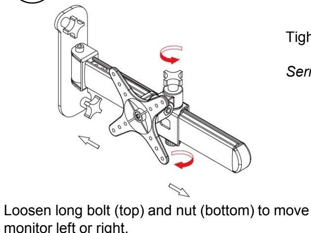
Desserrez le boulon long (en haut) et l'écrou (en bas) pour déplacer le moniteur vers la gauche ou la droite.
