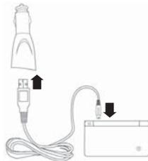
2 Insérer l'adaptateur de voiture CC dans une douille d'allume-cigare standard de 12 V CC ou dans une douille pour accessoires. Vérifier que la prise est correctement insérée dans la douille.
