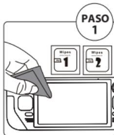
Utilice el paquete 1 (húmedo) de toallitas para limpiar la pantalla Steam Deck. Antes de colocar el protector de pantalla, debe eliminar todas las huellas, el polvo y la suciedad. Utilice el paquete 2 (seco) de toallitas para eliminar cualquier resto de humedad que quede en la pantalla.
