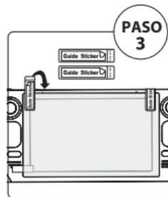
Use las dos pegatinas de alineación para alinear el protector de pantalla con la esquina de su pantalla y presione hacia abajo de la izquierda a la derecha para pegarlos.
