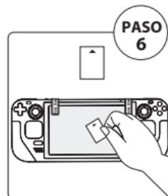
Utilizando el borde de la tarjeta aplicadora, presione lentamente el protector de pantalla con un movimiento de barrido. Si hay burbujas de aire, empújelas hacia el borde más cercano al la tarjeta aplicadora. Por último, retire las dos pegatinas de guía.
