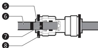
**5** Collet **6** Tube **7** Ligne d'insertion **8** Attache
