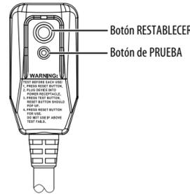
El cortacircuitos tiene que estar probado regularmente presionando el botón de prueba (**TEST**) y el botón de restablecimiento (**RESET**). Si el botón de prueba (**TEST**) no hace que se dispare el cortacircuitos o si el botón de restablecimiento (**RESET**) no se queda activado, desenchufe inmediatamente el aire acondicionado y contacte un técnico de Insignia.
