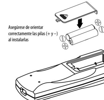
Asegúrese de orientar correctamente las pilas (+ y -) al instalarlas
