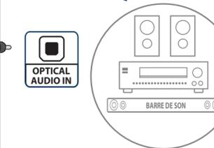
Il est possible d'utiliser la prise de **SORTIE OPTIQUE NUMÉRIQUE** ou la prise **HDMI 1 (ARC)**.
