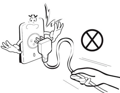
Pour débrancher, tirez sur l'extrémité de la fiche plutôt que sur les fils.
