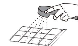
Si le filtre est sale, nettoyez-le dans de l'eau tiède à 40 °C (104 °F) ou dans de l'eau avec un détergent neutre.
