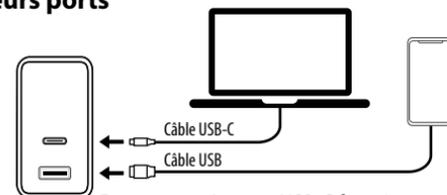
**Remarque :** Le port USB-C fonctionne mieux pour un portatif lorsque plusieurs ports se chargent simultanément.
