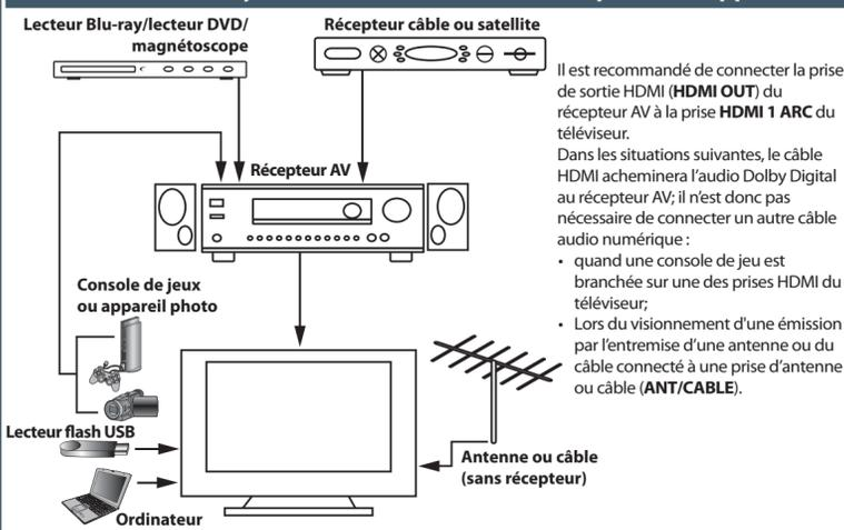
Il est recommandé de connecter la prise de sortie HDMI (**HDMI OUT**) du récepteur AV à la prise **HDMI 1 ARC** du téléviseur. Dans les situations suivantes, le câble HDMI acheminera l'audio Dolby Digital au récepteur AV; il n'est donc pas nécessaire de connecter un autre câble audio numérique :
