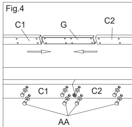
**FR:** Fig.4 : Insérez le tube de connecteur (G) sur le linteau (C1) et le linteau (C2), assurez-vous que les trous sont alignés. Utilisez ensuite le boulon (AA) pour connecter le linteau (C1), le linteau (C2) et le tube de connecteur (G).
