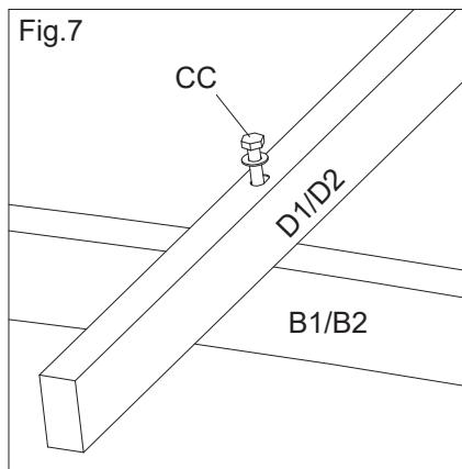
**FR:** Fig.7 : Utilisez le boulon (CC) pour relier le tube de toit courbé (B1) et les tubes de toit (D1) / le tube de toit courbé (B2) et les tubes de toit (D2) / le tube de toit courbé (B1) et les tubes de toit (D2) / Tube de toit courbé (B2) et tubes de toit (D1).
