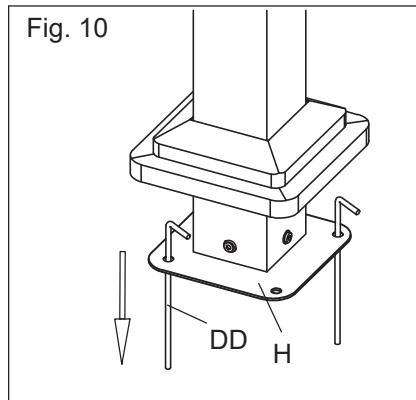
**FR:** Fig.10 : Relevez le couvercle de la plaque de base (J), insérez l'ancrage (DD) dans la plaque de base (H). Attachez la corde en tissu sur le poteau (A1/A2).
