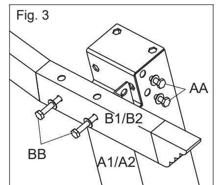
**FR:** Fig.3 : Utilisez le boulon (AA) et le boulon (BB) pour connecter le tube de toit incurvé (B2) et le poteau (A2), et utilisez le boulon (AA) et le boulon (BB) pour connecter le tube de toit incurvé (B1) et le poteau (A1).
