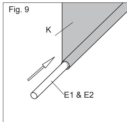
**FR:** Fig.9 : Passez le tissu d'ombrage (K) à travers le tube de toit (D1/D2) tour à tour comme sur le schéma ci-dessus. Assurez-vous que le linteau (C1/C2) sur le bord supporte le tissu d'ombrage (K) en dessous. Insérez la tige de traction (E1/E2) sur le tissu d'ombrage (K). Une fois assemblé, veuillez tirer le tissu du store (K) pour vous assurer qu'il fonctionne correctement.
