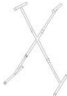
9 Enclencher les supports supérieurs dans les supports supérieurs en T. Vérifier que la partie arrondie des goupilles des supports est orientée vers le dessus des supports supérieurs en T.
