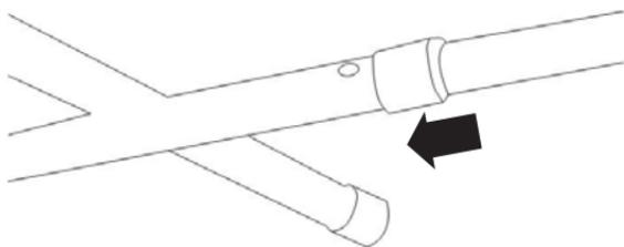
7 Aligner les orifices du support supérieur en T et le croisillon, puis insérer une goupille de fixation dans les orifices.
