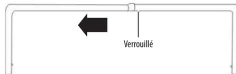
11 Insérer la barre inférieure en U dans les pieds du piédestal jusqu'à enclenchement.
