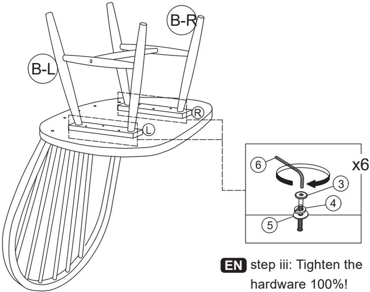
**EN** step iii: Tighten the hardware 100%!
