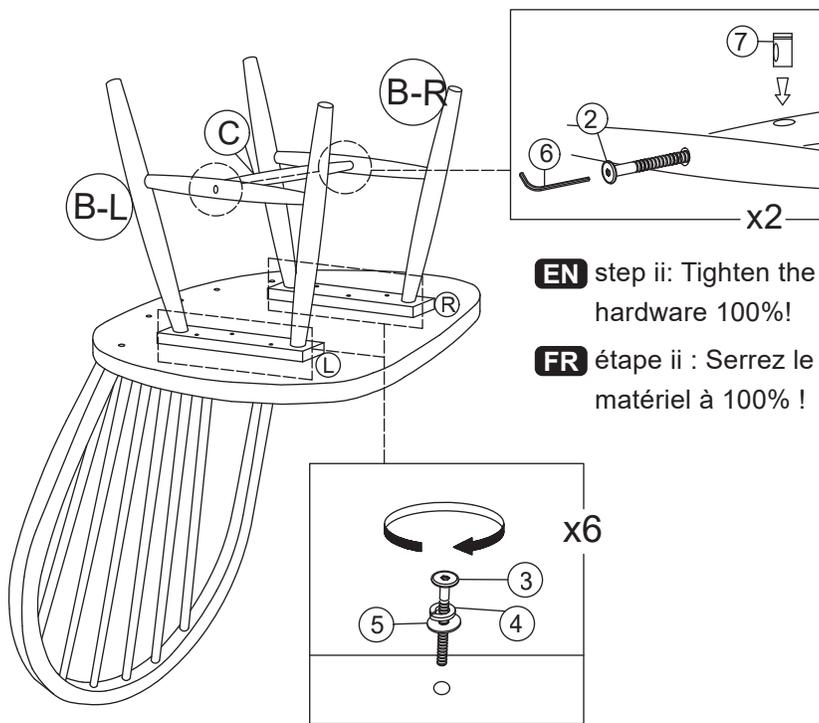
**EN** step ii: Tighten the hardware 100%!
