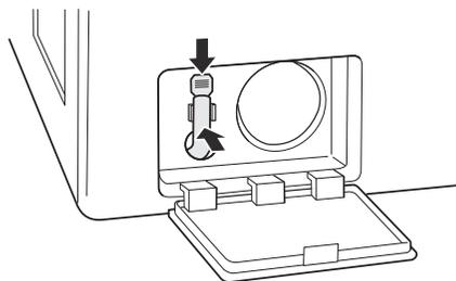
**7** Inserte el filtro de la bomba de desagüe y gírelo hacia la derecha.
