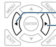
Presione el botón direccional derecho o izquierdo para mover el cursor en la pantalla o para ajustar un elemento seleccionado.
