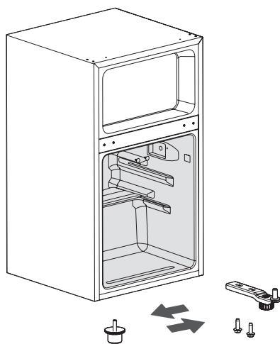
6. Coloque la puerta de la cámara de refrigeración en la bisagra inferior, luego fije la bisagra central en el lado izquierdo e inserte las tapas de los agujeros en el lado derecho;
