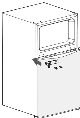
7. Coloque la puerta de la cámara del congelador en la bisagra central, luego fije la bisagra superior, la cubierta de la bisagra superior en el lado izquierdo e inserte las tapas de los agujeros en el lado derecho.
