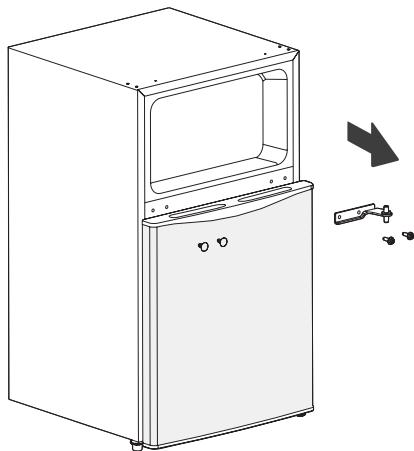
4. Retire la puerta de la cámara de refrigeración y desmonte la bisagra inferior y el pie ajustable.
