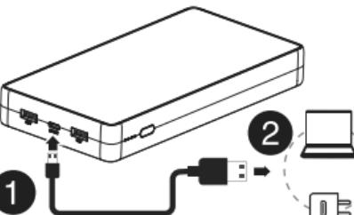
**1** Brancher la grande extrémité du câble USB inclus dans un des ports USB **OUT** de la batterie.
