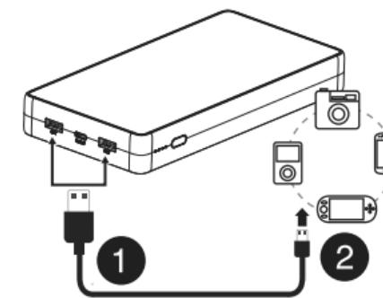
**1** Brancher la grande extrémité du câble USB inclus dans un des ports USB **OUT** de la batterie.
