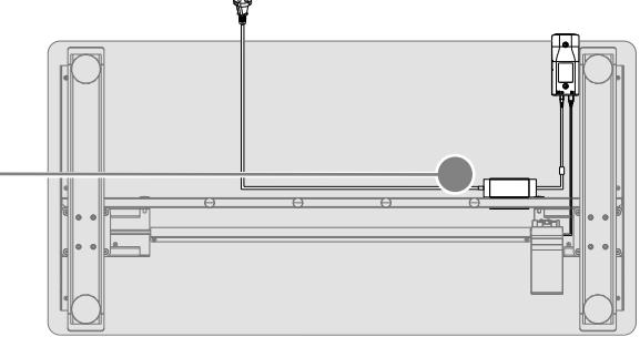
4 Connecter le câble de l'adaptateur ⑨ au port c.c. Connecter le câble du moteur au port M1 (voir les détails).
