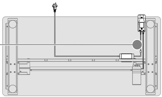
3 Brancher le petit connecteur du câble d'alimentation sur le connecteur femelle de l'adaptateur (voir les détails).
