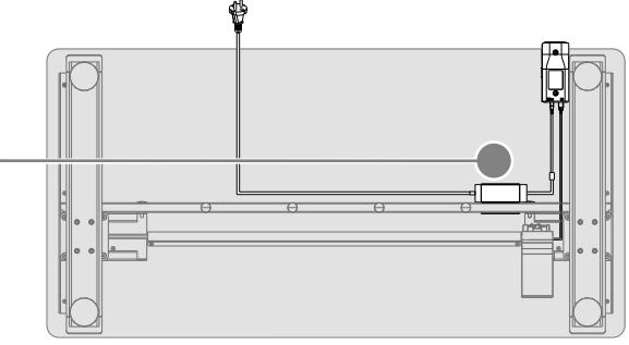
2 Connecter le câble du commutateur au câble de l'adaptateur ⑥, puis les attacher ensemble (voir les détails).
