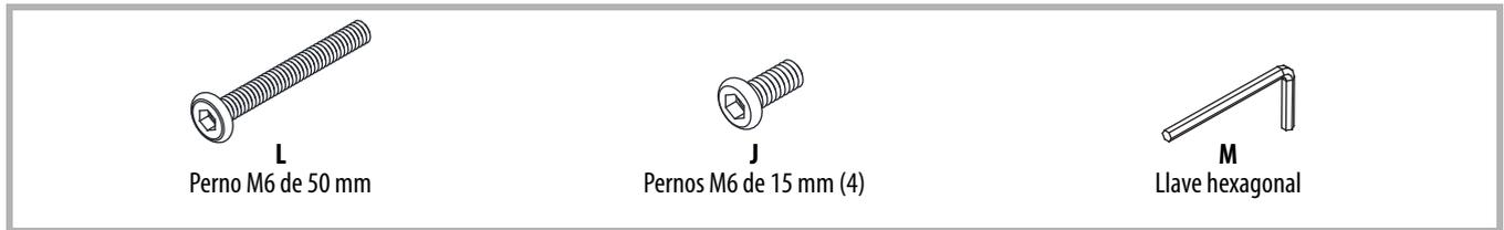
**Nota:** Para facilitar el montaje, no bloquee los pernos con fuerza hasta que haya montado todas las demás piezas.
