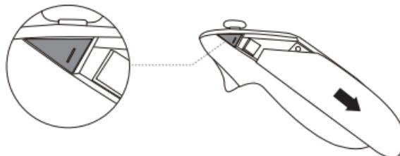
2. Instale el paquete de baterías recargables asegurándose de que está alineado con la polaridad correcta. Deslice la tapa de la batería personalizada en el control.
