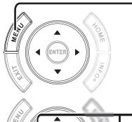
Presione el botón direccional derecho o izquierdo para mover el cursor en la pantalla o para ajustar un elemento seleccionado.
