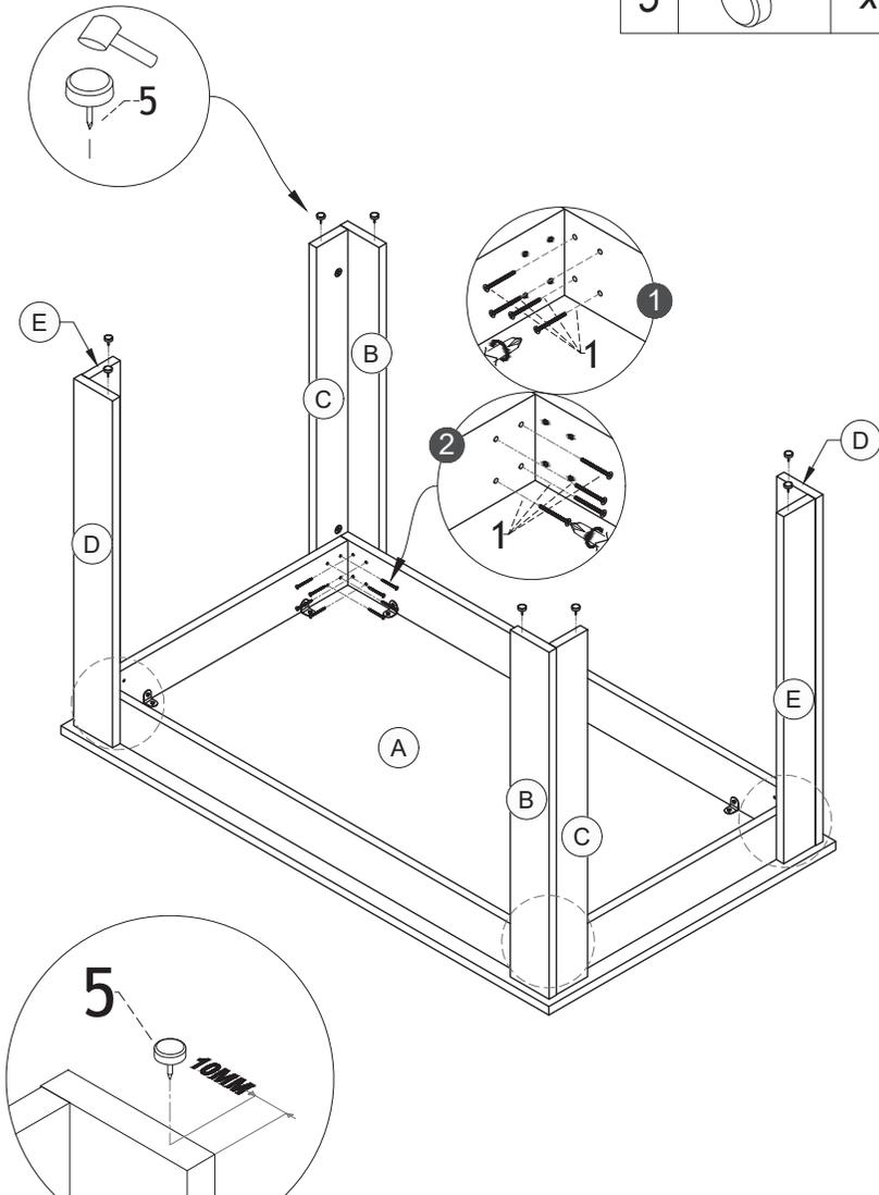
**EN: WARNING : THE FRONT NAIL LEG MUST FIX AT 10MM FROM FRONT.**
