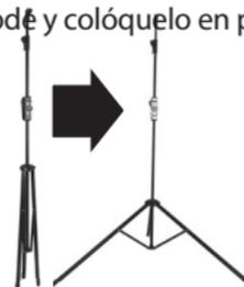
**2** Libere la palanca de bloqueo de la columna central, después levante la columna central para que la ranura del colgador de la pantalla quede por debajo del nivel de sus ojos (esta posición hace que sea más fácil la sujeción del colgador de colgado de la pantalla) y apriete la palanca de bloqueo de la columna central para asegurarla en su lugar.
