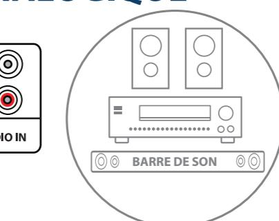
Il est possible d'utiliser la prise de **SORTIE OPTIQUE NUMÉRIQUE** ou la prise **HDMI 1 (ARC)**.
