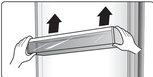
L'étagère au centre de la porte est réglable et peut être disposée à différentes hauteurs. Avant le réglage, enlever les aliments de l'étagère.
