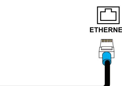
**Remarque :** Il est possible d'utiliser une connexion filaire Ethernet pour accéder à l'Internet au lieu d'une connexion Wi-Fi. Connecter un câble Ethernet à la prise **ETHERNET** sur le téléviseur et à la connexion Ethernet.
