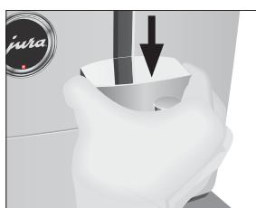
► Replacez le couvercle de l'écoulement combiné. Il s'enclenche avec un clic audible.
